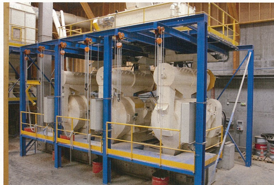
► Vue d'ensemble des presses assurant le compactage des pellets de bois / General view of the presses compacting the wood pellets (doc. BERTHOLD).
